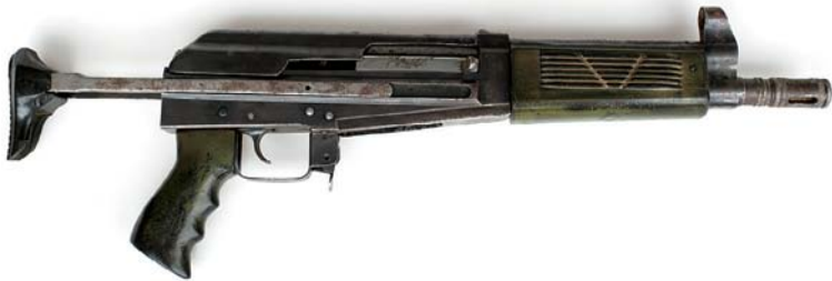
Výrobek pákistánských puškařů a zámečnicků, kombinace vlivů několika zbraní, sovětského AK-47 a německé pušky G3, zbraň postrádá hledí a je velmi hrubě vyrobená doslova „na koleně“, možná ve známém městě ilegálních výrobců zbraní Darra Adam Chel.
